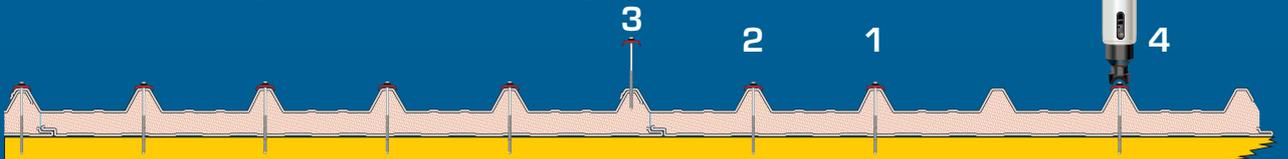
Dieses Beispiel zeigt eine komplett **fehlerhafte** Verlegung/Verschraubung eines Dachpaneeles.
